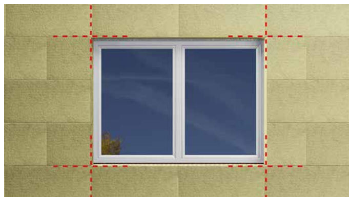
RYS.13 Błędne rozmieszczenie płyt z wełny mineralnej
