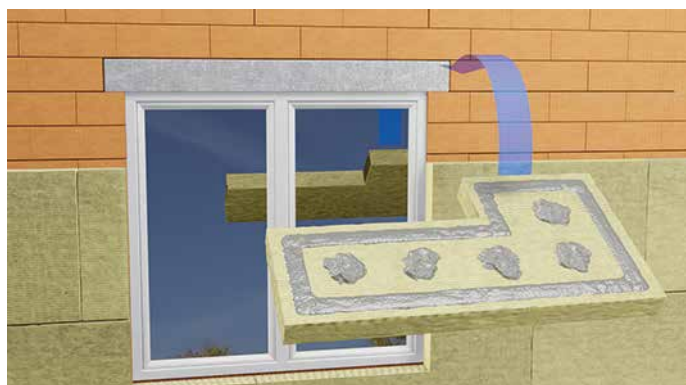
RYS.11 Prawidłowe przycięcie wełny w narożach
