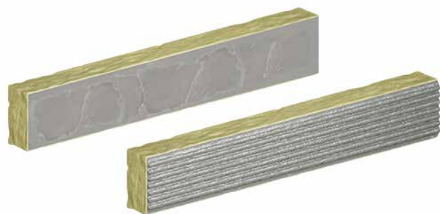
RYS.8 Prawidłowe klejenie płyt z wełny lamelowej
