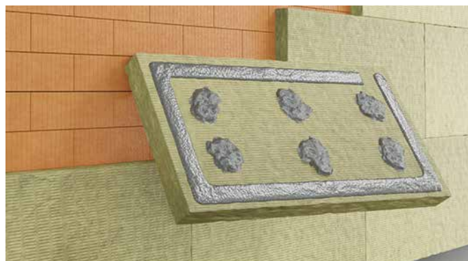
RYS.9 Mocowanie płyt z wełny mineralnej
